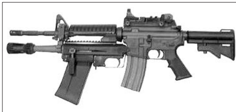
Рис. 4. Многоцелевой комплекс стрелкового оружия, состоящий из карабина M4A1 и установленного на нем ружья XM-26 (подствольный вариант)
