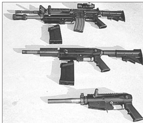
Рис. 9. Ружье XM-26 в трех основных конфигурациях (сверху вниз: подствольный вариант, вариант для самостоятельного использования, компактное оружие)
