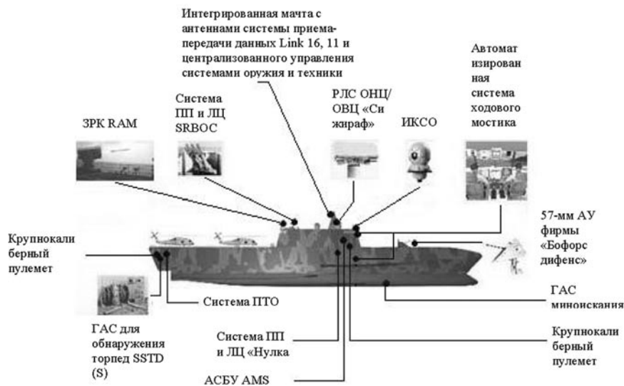
Рис. 5. Состав оружия и радиоэлектронного оборудования корабля LCS фирмы «Дженерал дайнэмикс»
