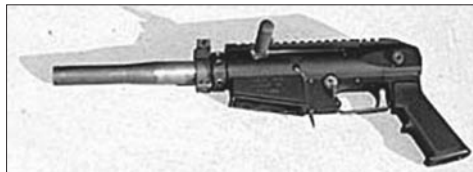
Рис. 8. Ружье XM-26 в компактном варианте (имеется пистолетная рукоятка; адаптер с целью использования специальных боеприпасов для выбивания дверей со ствола ружья снят)
